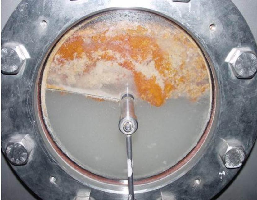
Fettabscheider ohne die Zugabe des BioEmu-Spalter
