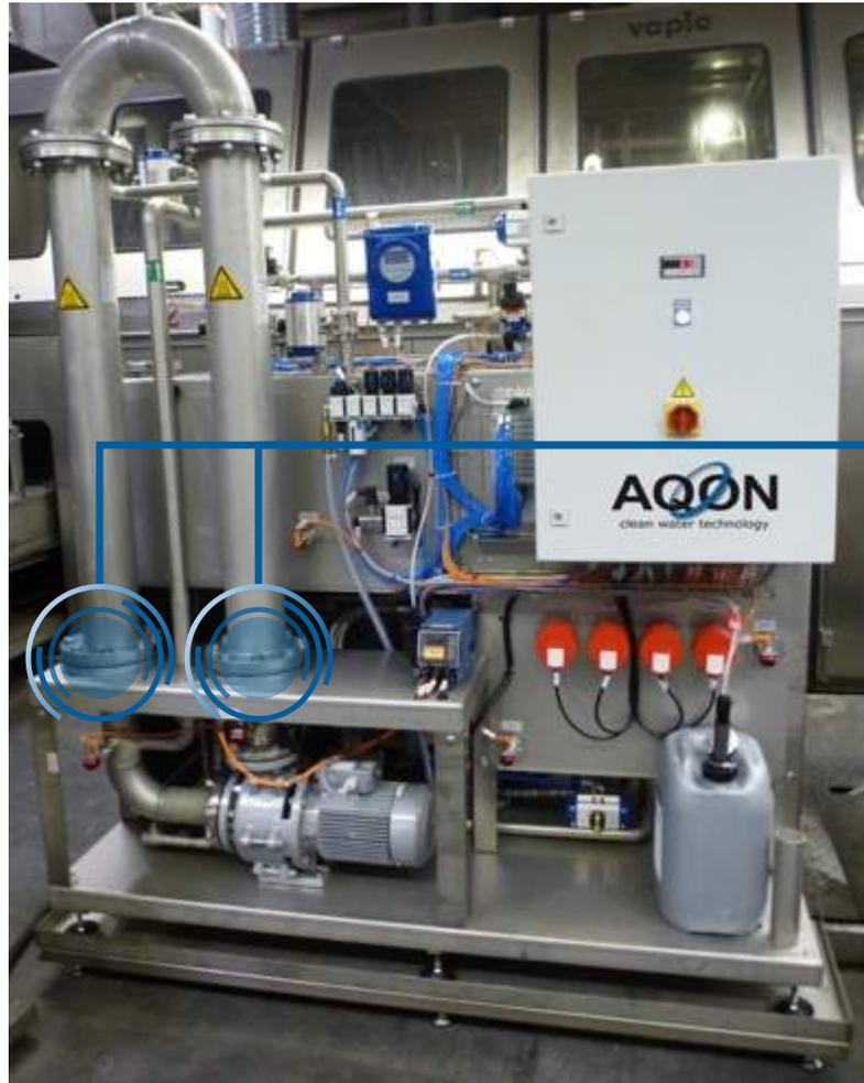
Bild: AQON Membranfilteranlage zur Reinigung von fett- und ölhaltigen Abwässern.
